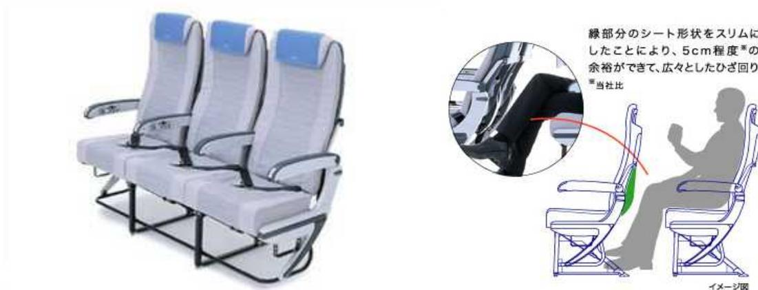
これは2005年度から全日空が導入した一般席に新たに投入したシートである。このシートの特徴は、人間工学の骨盤支持と背筋支持という観点と取り入れ、背中や腰への負担が軽減される様に設計されている。また、膝から下までのスペースが従来より広がっているのに加え、コートフックや小物用のポケットを採用して、従来よりも格段に快適性が向上している。
